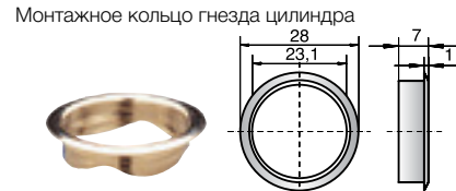
Монтажное кольцо гнезда цилиндра Внимание: при установке замка с монтажным кольцом отверстие под врезку должно быть 23-24 мм, толщина двери может быть увеличена на 4 мм. Материал: латунь; варианты обработки: 401746 – CR; 401747 – MCR; 455142 – KI
