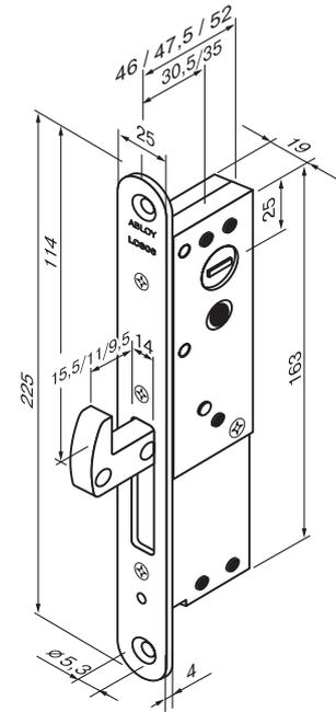
Замок для наружных профильных дверей.
