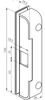
Запорная планка накладного монтажа для внутренних стеклянных или тонких дверей; для монтажа с установочной коробкой 2051. Ms/CR, Ms/HA
