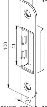
Запорная планка для внутренних дверей со специальным боксом для отверстия под ригель
