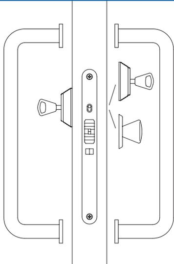
Замок для наружных складных и раздвижных дверей.
