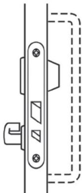
Замок с автоматическим запирающим устройством для одностворчатых дверей экстренного выхода.
