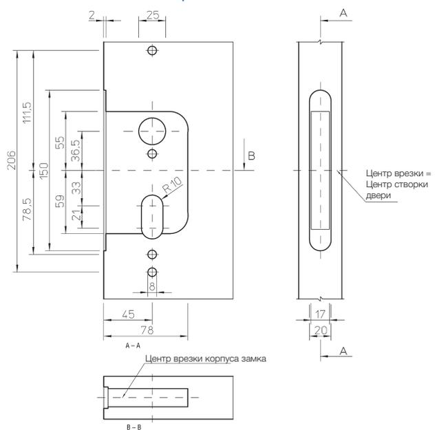
\*ВНИМАНИЕ! Размеры врезок указаны для примера. Более точная информация дана на чертеже, прилагаемом к замку.
