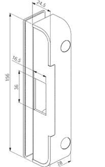
Запорная планка накладного монтажа для внутренних стеклянных или тонких дверей; для монтажа с установочной коробкой 2051. Ms/CR, Ms/HA
