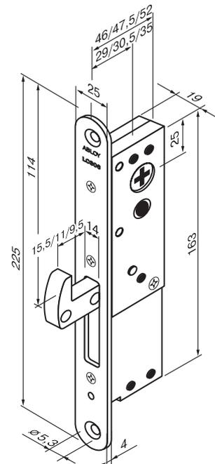
Замок для наружных профильных дверей.
