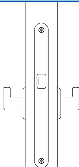
Защелка для противопожарных дверей.
