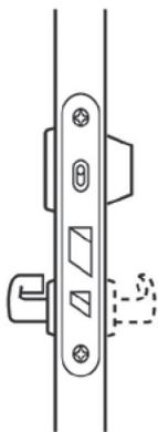
Замок с автоматическим запирающим устройством для одностворчатых дверей экстренного выхода.
