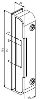
Запорная планка накладного монтажа для внутренних стеклянных или тонких дверей; для монтажа с установочной коробкой 2050. Ms/CR, Ms/HA
