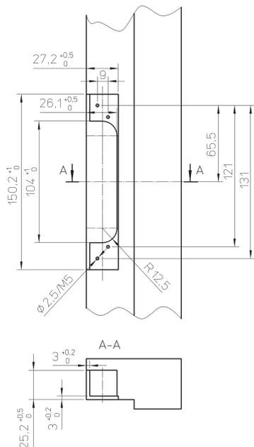
\*ВНИМАНИЕ! Размеры врезок указаны для примера. Более точная информация дана на чертеже, прилагаемом к замку.
