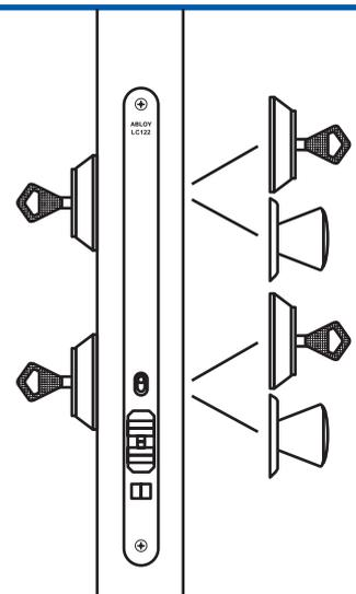
Замок для наружных складных и раздвижных дверей.
