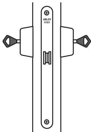
Замок для наружных дверей повышенной надежности.
